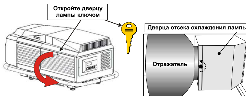
Рис. 2-10 Откройте дверцу лампы и отсека охлаждения
