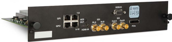
Изображение 4-7 Пример IMB на основе технологии Doremi.
