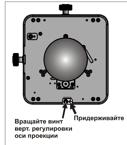
Рис. 2-25 Отрегулируйте вертикальное положение оси проекции
