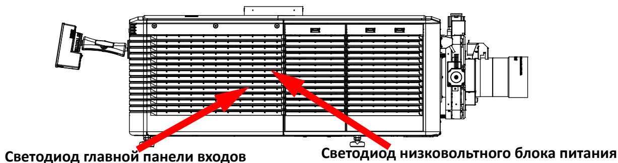
Рис. 5-2 Индикаторы состояния питания
