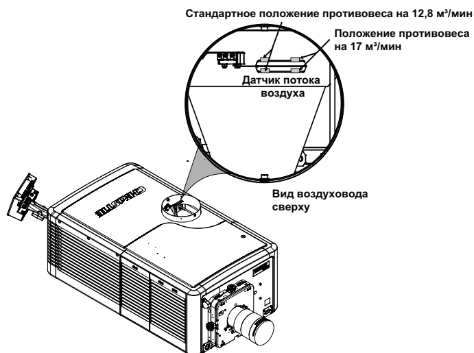
Рис. 2-10 Датчик потока воздуха со встроенным выключателем
