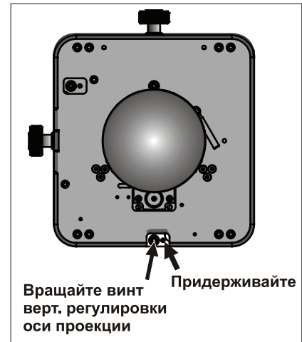
Рис. 2-27 Отрегулируйте вертикальное положение оси проекции
