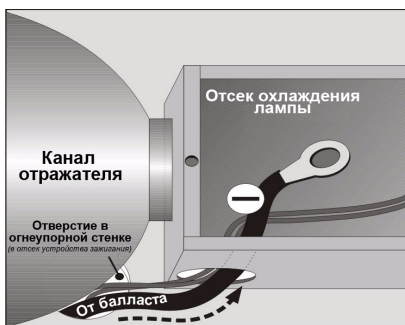
Рисунок 3-11 Прокладка черного провода в отсек
