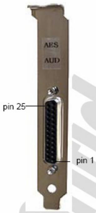
Рисунок 11: цифровой аудио интерфейс
