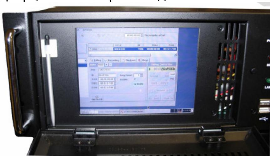
Рисунок 3: DCP 2000 передняя панель, левая дверца открыта – сенсорный дисплей.
