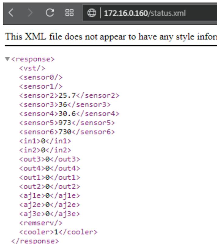
Рисунок 19 – пример ответа на http запрос о состоянии устройства
