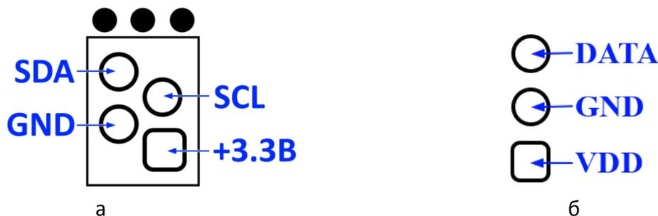
Рисунок 10 – а). Распиновка разъемов «J1» и «J2» для подключения датчика давления;
