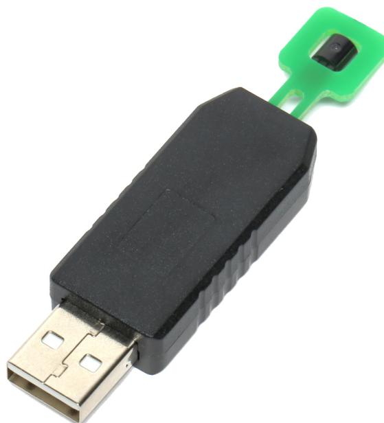
Рисунок 1 – Общий вид устройства со встроенным датчиком DS18B20
